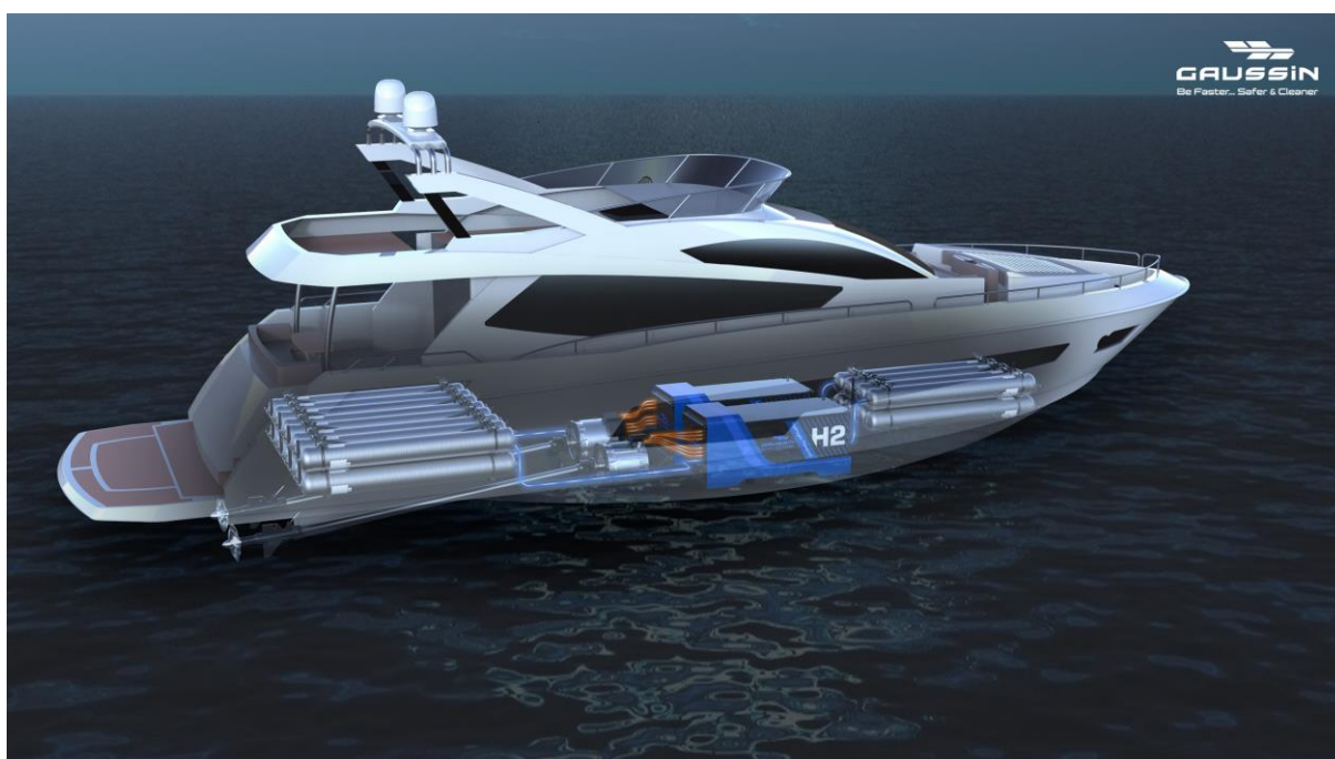
Système 100% hydrogène pour un bateau zéro-émission
